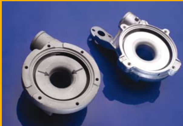
7.9 Carter compresseur endommagé à côté d'un carter neuf
