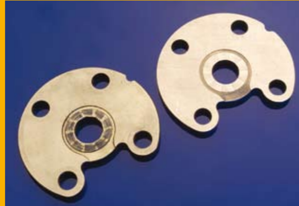
7.7 Palier axial endommagé à côté d'un palier axial neuf
