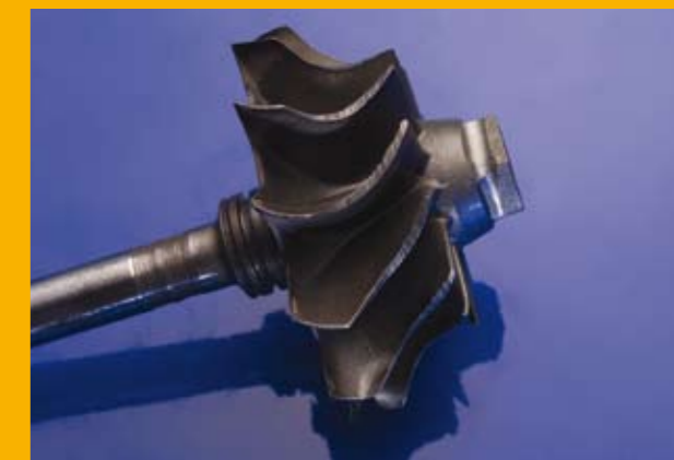
7.3 Frottement de la roue de turbine
