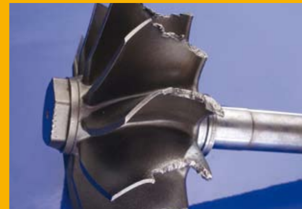
7.12 Impact d'un objet étranger sur l'arbre de turbine
