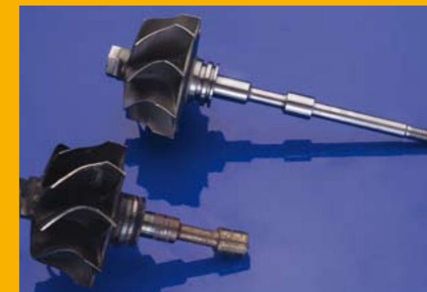
7.4 Arbre de turbine cassé
