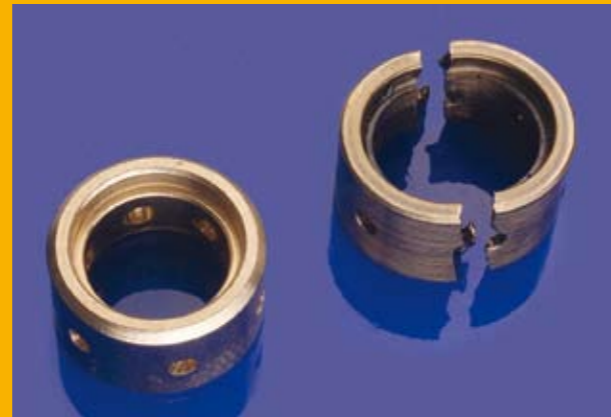
7.11 Palier radial neuf à côté d'un palier radial cassé.
