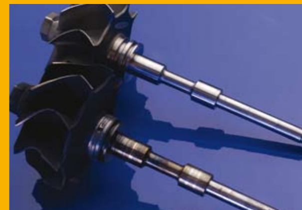
7.1 Coloration de l'arbre de turbine
