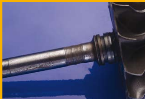
7.20 Points d'encastrement usés sur l'arbre de turbine
