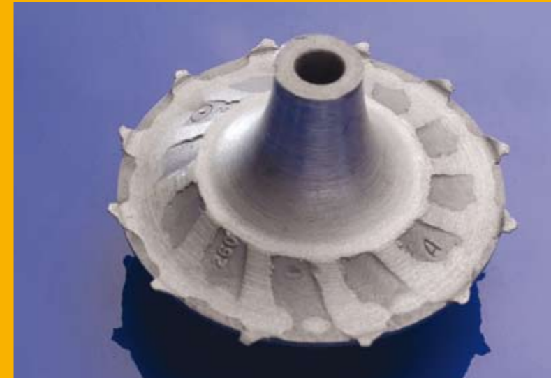
7.14 Impact d'un objet étranger sur la roue de compresseur
