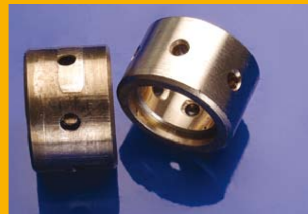
7.2 Palier endommagé à côté d'un palier neuf
