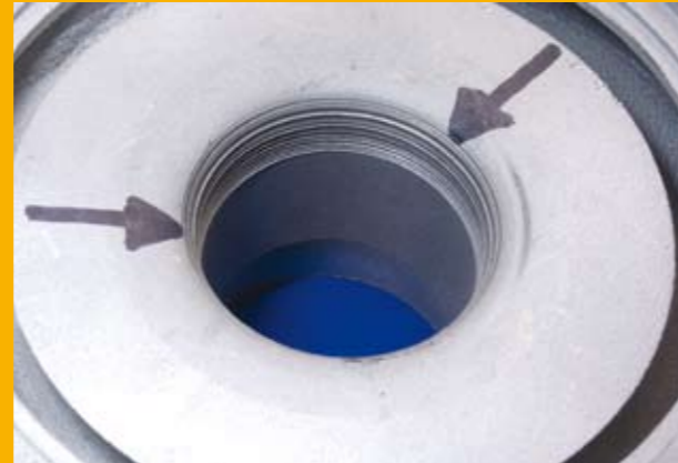
7.10 Frottement dans le carter compresseur
