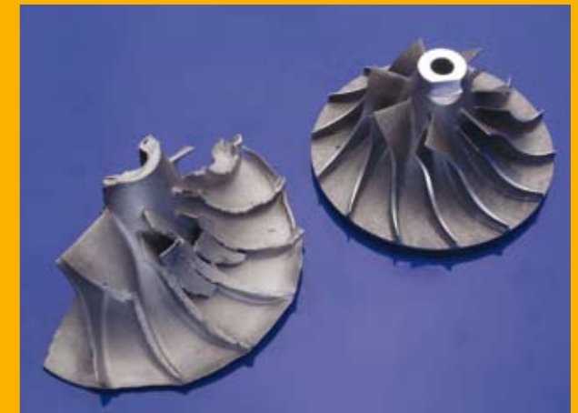
7.25 Roue de compresseur cassée
