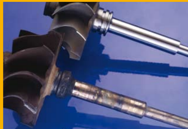
7.21 Arbre de turbine endommagé et nouvel arbre de turbine
