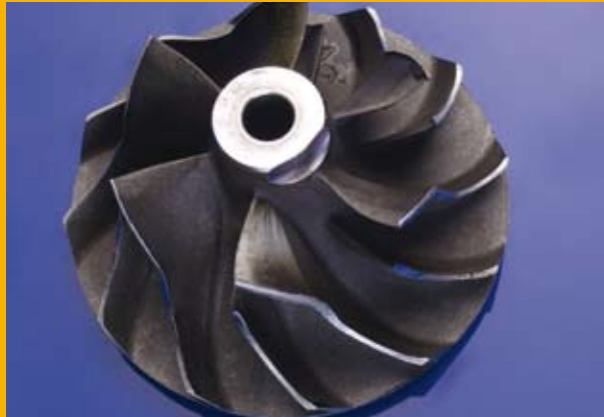
7.8 Frottement de la roue de compresseur
