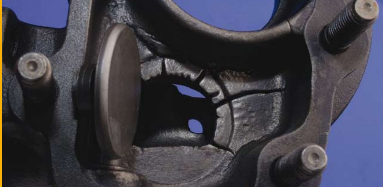
7.23 Fissures dans le carter de turbine
