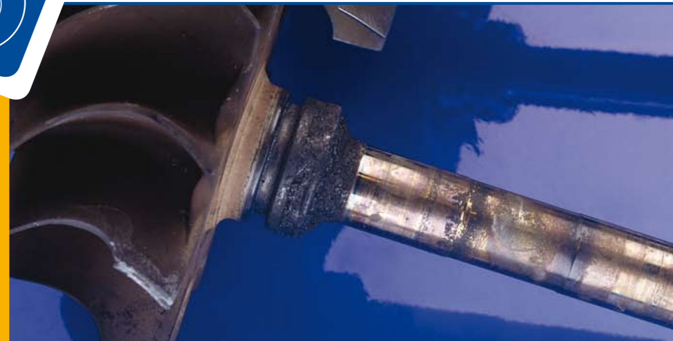
7.22 Usure de la gorge de segment de l'arbre de turbine
