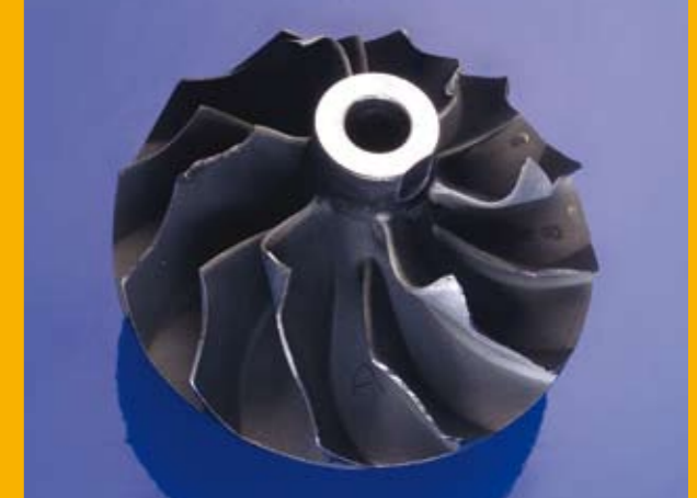
7.24 Roue de compresseur endommagée
