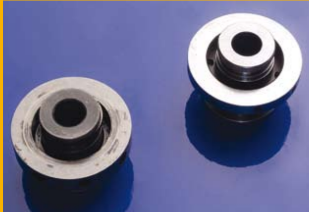
7.6 Porte-segment endommagé à côté d'un porte-segment neuf
