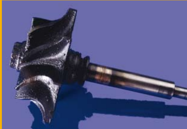
7.5 Dépôt de cuivre sur l'arbre de turbine
