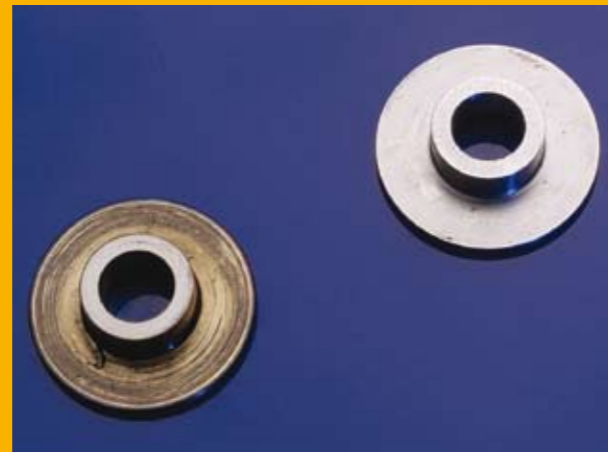
7.17 Collet de palier endommagé et nouveau collet de palier
